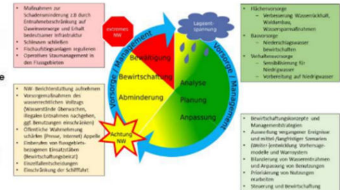
Abbildung 4: Kreislaufschema mit Maßnahmen der Niedrigwasserversorgung und des Niedrigwassermanagements
